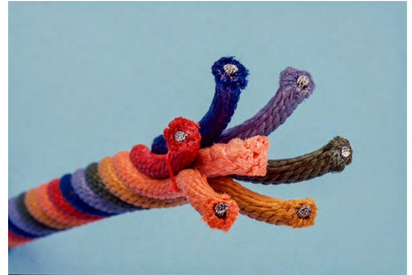
Varianten in der Beschaffenheit der mit Stahldraht verstärkten Seile
